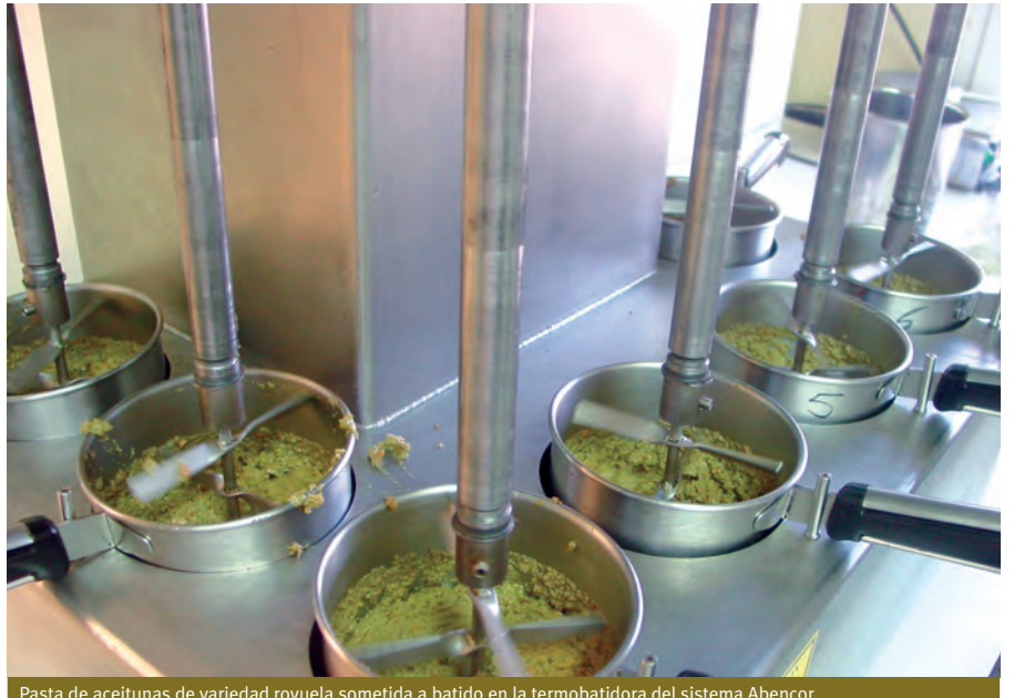
Pasta de aceitunas de variedad royuela sometida a batido en la termobatidora del sistema Abencor.
